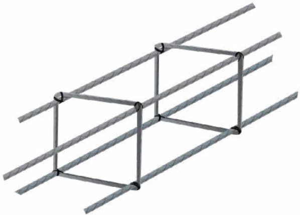
EJEMPLO DE ARMADO DE DALA O COLUMNA
