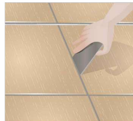
EMBOQUILLADO DEL PISO
