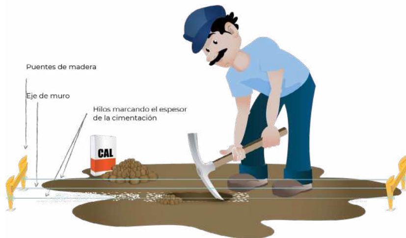
REALIZACIÓN DE EXCAVACIÓN
