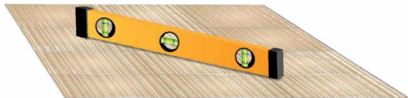
NIVELACIÓN DE PISO
