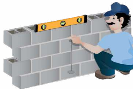
NIVELACIÓN Y PLOMEADO DE MURO
