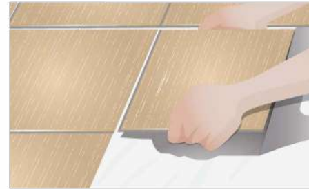
COLOCACIÓN DE PIEZA DE PISO CERÁMICO
